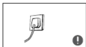
El cable de alimentación debe estar firmemente conectado a la toma de corriente, ya que de lo contrario podrían producirse incendios. Asegúrese de que el electrodo de conexión a tierra de la toma de corriente esté equipado con una línea de conexión a tierra fiable.
