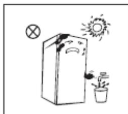
Estálejos de al fuente de calor, evitando la luz solar directa. No lo coloque en el lugar húmedo o el con agua, evitando estar mohoso o reducir los efectos de aislamiento.
