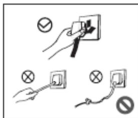
No tire del cable de alimentación al desconectar el enchufe de la nevera. Sujete firmemente el enchufe y desenchúfelo directamente de la toma de corriente.
