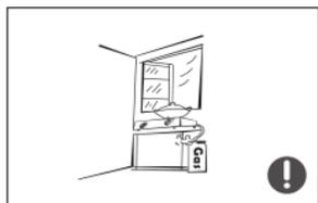
Por favor, cierre la válvula de la fuga de gas y a continuación abra las puertas y ventanas en caso de fuga de gas y otros gases inflamables. No desenchufe la nevera y otros aparatos eléctricos, ya que las chispas pueden provocar un incendio.
