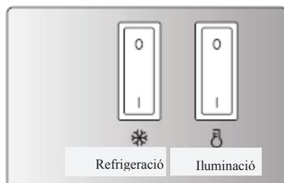
La vitrina comercial se equipa con el sistema indicial de refrigeración y iluminación, el sistema de control se sitúa en la cubierta de superficie de salida de viento en la parte baja de la vitrina, se puede controlar la refrigeración y iluminación de la vitrina comercial por los interruptores de refrigeración y iluminación.
